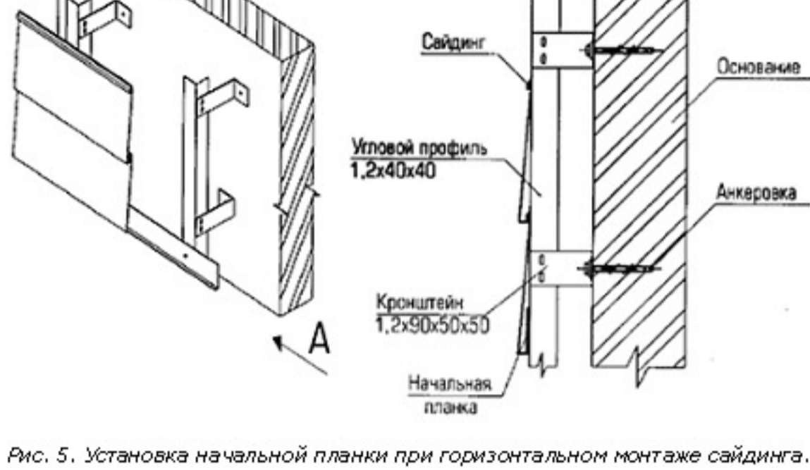
Рис. 5. Установка начальной планки при горизонтальном монтаже сайдинга.
