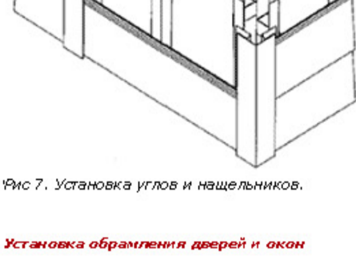
Рис. 7. Установка углов и нащельников.
