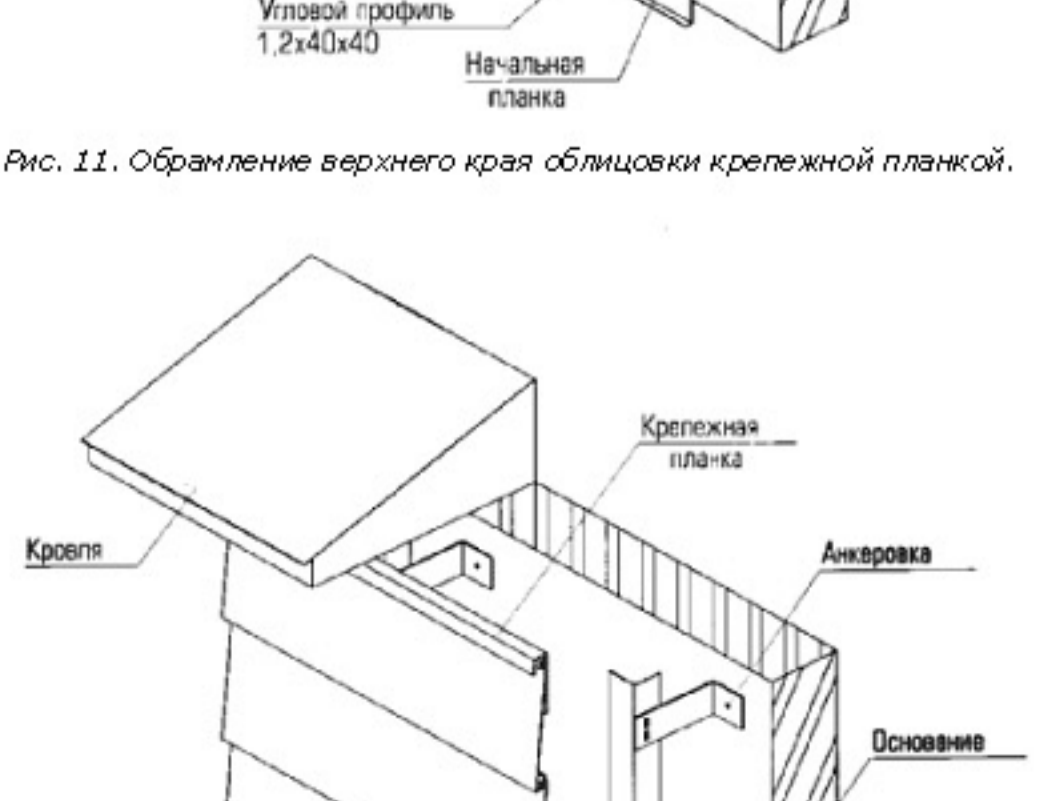
Рис. 12. Обрамление верхнего края облицовки верхним отливом.
